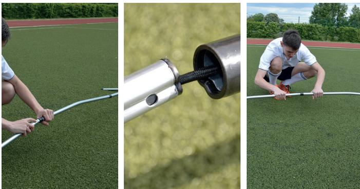
Stecken sie nun die Mittelstange in die beiden abgeklippten Stangen an den beiden Eckverbindern
