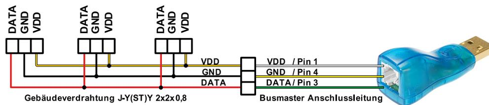
Für die Nutzung des gesamten Temperaturbereichs bis 125 °C, ist die Versorgung der Sensoren am Anschluss VDD mit 5 V DC erforderlich. Diese Spannung kann dem Busmaster entnommen werden. Wir empfehlen maximal 20 Sensoren an einem Busmaster anzuschließen.
