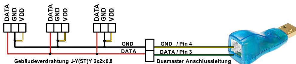
Der Oberflächentemperaturfühler kann parasitär über nur 2 Adern am Busmaster angeschlossen werden. Wir empfehlen pro Busmaster maximal 20 „parasitic“ Sensoren und eine Buslänge bis 100 m. Der nutzbare Temperaturbereich ist in dieser Variante auf -30 °C bis 85 °C beschränkt.
