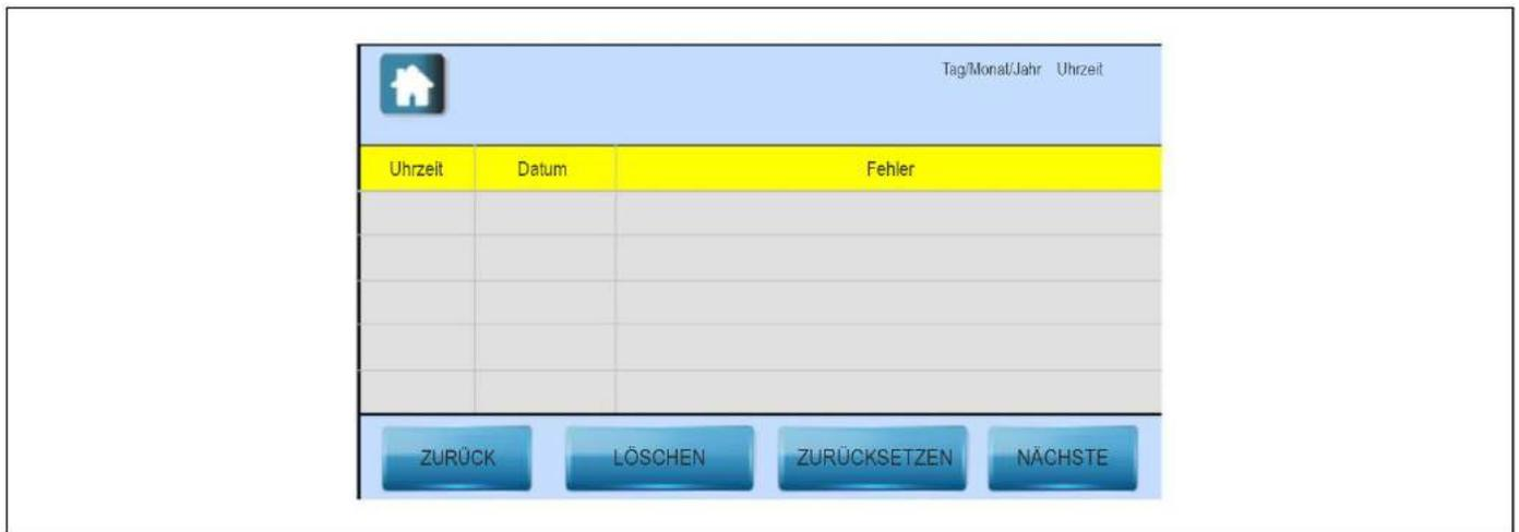
In diesem Menü kann der Benutzer die Uhrzeit und das Datum jedes der erkannten Alarmcodes einsehen, den aktuellen Alarmcode zurücksetzen (falls vorhanden) und die gesamte Historie der Störungen löschen. Die folgende Tabelle zeigt eine Liste der Alarmcodes, die erscheinen können:
