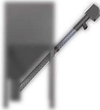
Eine Förderschnecke für den Transport von Pellets ist kostengünstig und bei passenden baulichen Gegebenheiten leicht zu realisieren. Der Einsatz einer Förderschnecke ist jedoch nur beim Transport der Pellets über kurze Distanzen möglich. Das Pelletlager sollte daher möglichst in unmittelbarer Nähe zum Pellet Heizraum liegen.
