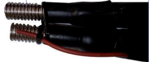
Das Ergebnis von falscher Dämmung: Dämmmaterial (EPDM) bereits nach einer Saison komplett verbrannt, Folie nach außen geschmolzen.
