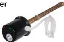
Die Elektroheizstäbe werden mit 3 U-förmigen Rohrheizkörpern (DM 6,5 mm) gefertigt, welche in einen Kopf aus Kunststoff befestigt sind. Die Köpfe sind mit Gewinde G 1 1/2" ausgeführt.
