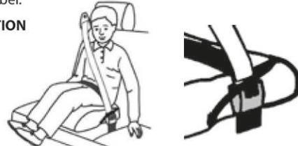
1. Die Basis muss auf dem Vorder- oder Rücksitz des Fahrzeugs unbedingt in Fahrtrichtung platziert werden, so dass ihr Rücken an der Rückenlehne des Sitzes anliegt. Nachdem das Kind auf dem Sitzerhöher platziert wurde, schieben Sie die Basis erneut gegen die Rückenlehne des Autositzes und schnallen Sie den Sicherheitsgurt an.
