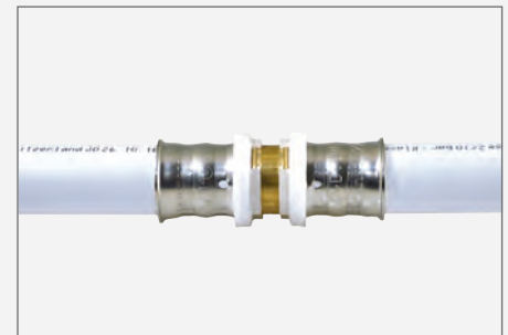
ZWISCHEN 1 UND 4,5 BAR GEPRÜFT VERPRESSTER FITTING - DICHT / RACCORD SERTI, TEST EN PRESSION À 1-4,5 BAR IL NE FUIT PAS
