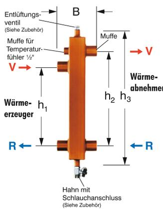
MAGRA-WST Hydraulische Weiche best. aus: Tauscherkammer aus Stahl mit aufgeschweißten Endböden. 4 Anschlussmuffen für Wärmeabnehmer und Wärmeerzeuger, 1 Muffe 1/2" für Temperaturfühler und je 1 Muffe 1/2" in den Endböden für Entlüftung bzw. Entleerung. Die Hydraulische Weiche ist werkseitig druckgeprüft und grundiert. Betriebsüberdruck max. 6 bar / Betriebstemperatur bis 110 °C.
