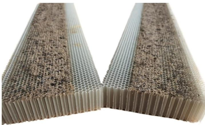
An diesem Bild kann man erkennen, dass eine relativ starke Verschmutzung im oberen (nicht sichtbaren Bereich) von unten (sichtbarer Bereich) nicht zu erkennen ist.
