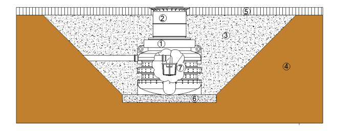
Abmessungen Grundfläche (Grubensohle) und Tiefe der Baugrube (die tatsächliche Grundfläche der gesamten Baugrube richtet sich nach der Baugrubentiefe und der Bodenbeschaffenheit (Böschungswinkel nach DIN 4124))
