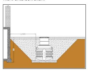
Die Böschung ist nach DIN 4124 anzulegen. Der Baugrund muss waagerecht und eben sein und eine ausreichende Tragfähigkeit gewährleisten.
