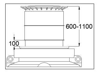
Der Bereich um den Schiebedom wird mit Kies der Körnung 4/8 in Lagen von 40 – 50 mm aufgefüllt und sorgfältig von Hand mittels eines Holzwerkzeuges verdichtet. (4 kg Fallgewicht, Fallhöhe 100 - 200 mm, 150 x 150 mm Verdichtungsfläche). Dann wird der Schiebedom auf Kiesniveau niedergedrückt und der Deckelrahmen mittels eines Holz- oder Gummiwerkzeuges in den Kies hinein verdichtet.
