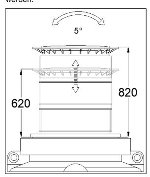
Zwischen dem minimalem und maximalen Wert ist der Dom stufenlos verschiebbar.
