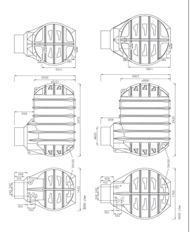
Rainwater utilisation: A Connection inflow DN 100; B connection service pipe DN 100; connection overflow DN 100 Regenwassernutzung: A Anschluss Zulauf DN 100; B Anschluss Versorgungsleitung DN 100; C Anschluss Überlauf **DN100**
