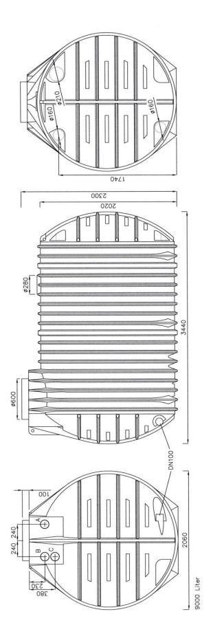
Regenwassernutzung: A Anschluss Zulauf DN 100; B Anschluss Versorgungsleitung DN 100; C Anschluss Überlauf DN100 Rainwater utilisation: A Connection inflow DN 100; B connection service pipe DN 100; connection overflow DN 100 (alternative) Anschlüsse Abwassertechnik: A,B,C und hintere Anschlussfläche:
