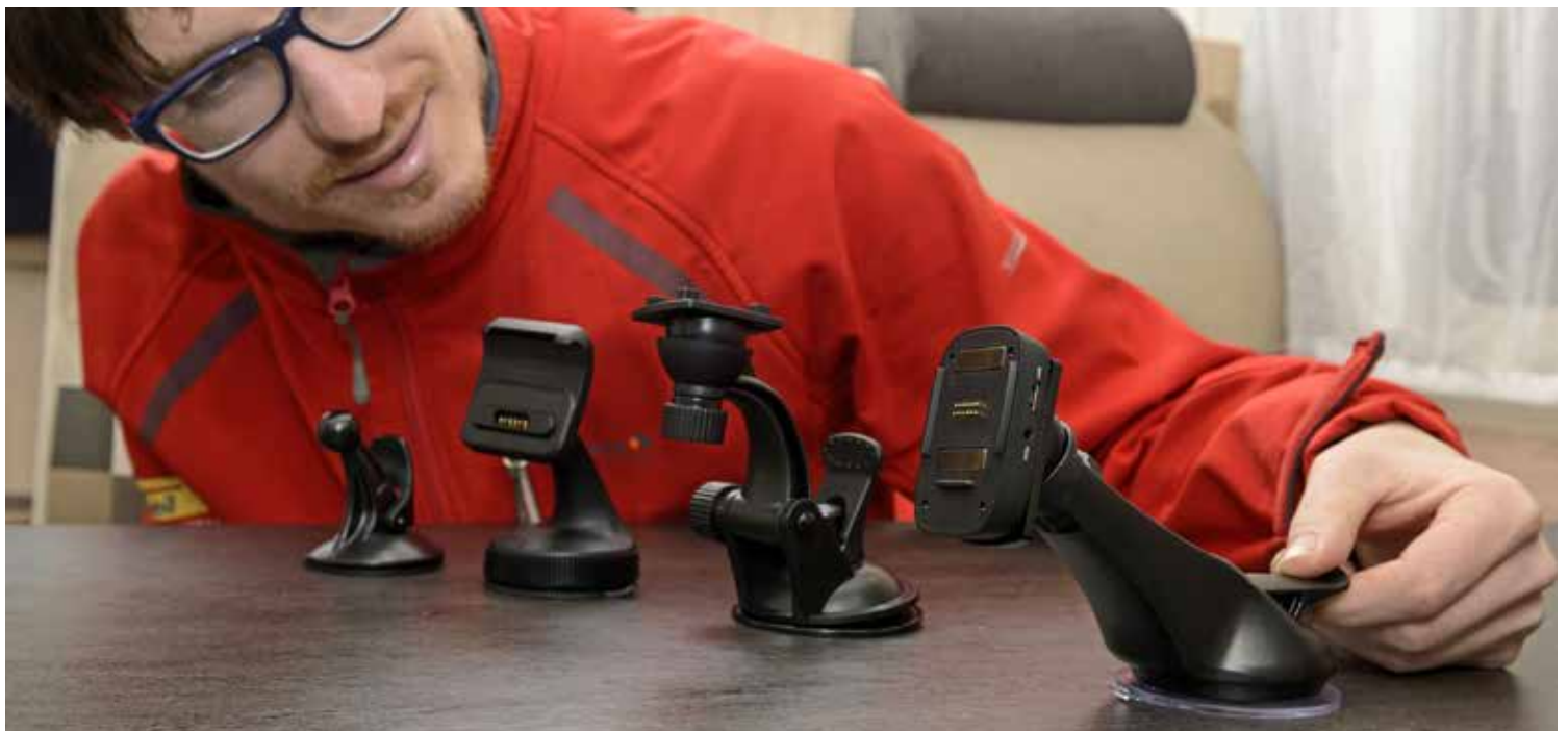
Die Halterungen und Geräteaufnahmen fallen bei jedem Navigationsgerät anders aus. Universallösungen zur Nachrüstung gibt es daher nicht. Auch, weil bei einigen Geräten die Stromversorgung in der Halterung steckt.
