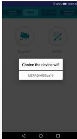
Sur certains systèmes Android, comme la version 4.0, la connexion peut ne pas être automatique et doit être établie manuellement. Si la Wi-Fi échoue, vous pouvez cliquer sur l'option "manual connect" et sur "jump" pour vous connecter. Recherchez le compte Wi-Fi en tant que "MSRADAR##" et le mot de passe par défaut : 88888888
