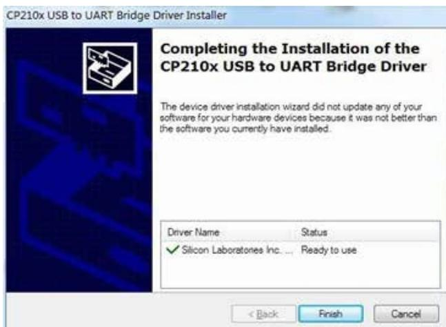
Si vous avez branché le câble sur le PC pendant l'installation du setup, veuillez débrancher le câble et et rebranchez le câble pour que le système reconnaisse l'appareil.
