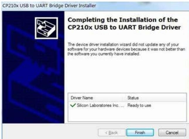
Si ha enchufado el cable en el PC durante la instalación, desenchufe el cable y vuelva a enchufar el cable para que el sistema reconozca el dispositivo. Conecte el adaptador USB a serie al puerto USB del PC. Windows debería reconocer el controlador como Silicon Labs CP210x USB to UART bridge. Vaya al administrador de dispositivos y busque el dispositivo "Silicon Labs CP210x Dispositivo "USB to UART Bridge" y el número de puerto COM asignado por Windows.
