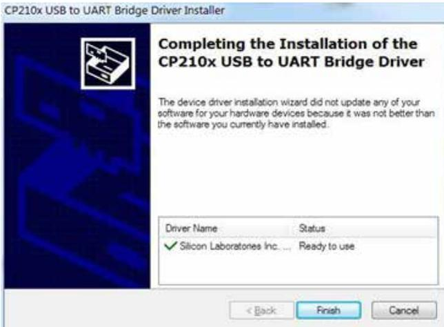
Wenn Sie das Kabel während der Setup-Installation in den PC eingesteckt haben, ziehen Sie bitte das Kabel ab und stecken Sie das Kabel wieder ein, damit das System das Gerät erkennt. Stecken Sie den USB-Seriell-Adapter in den USB-Anschluss des PCs. Windows sollte den Treiber als Silicon Labs CP210x USB-zu-UART-Brücke erkennen. Gehen Sie zum Gerätemanager und suchen Sie nach dem Gerät „Silicon Labs CP210x USB to UART Bridge“-Gerät und die von Windows zugewiesene COM-Port-Nummer.
