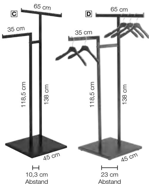
**Abhängeständer**, schwarz matt, 65 x 138 cm (B x H), 10,2 kg, belastbar bis 50 kg, zwei Abhänge-Arme mit Kantenstift und fixer Höhe, 118,5 und 138 cm hoch und 35 und 65 cm Armlänge, aus 20 mm Vierkant-Rahmen, stabile Bodenplatte 45 x 45 cm, hochwertige Pulver-Beschichtung für matte Optik verhindert Rost- und Korrosionsbildung für Langlebigkeit und Beständigkeit, Preis per Stück
