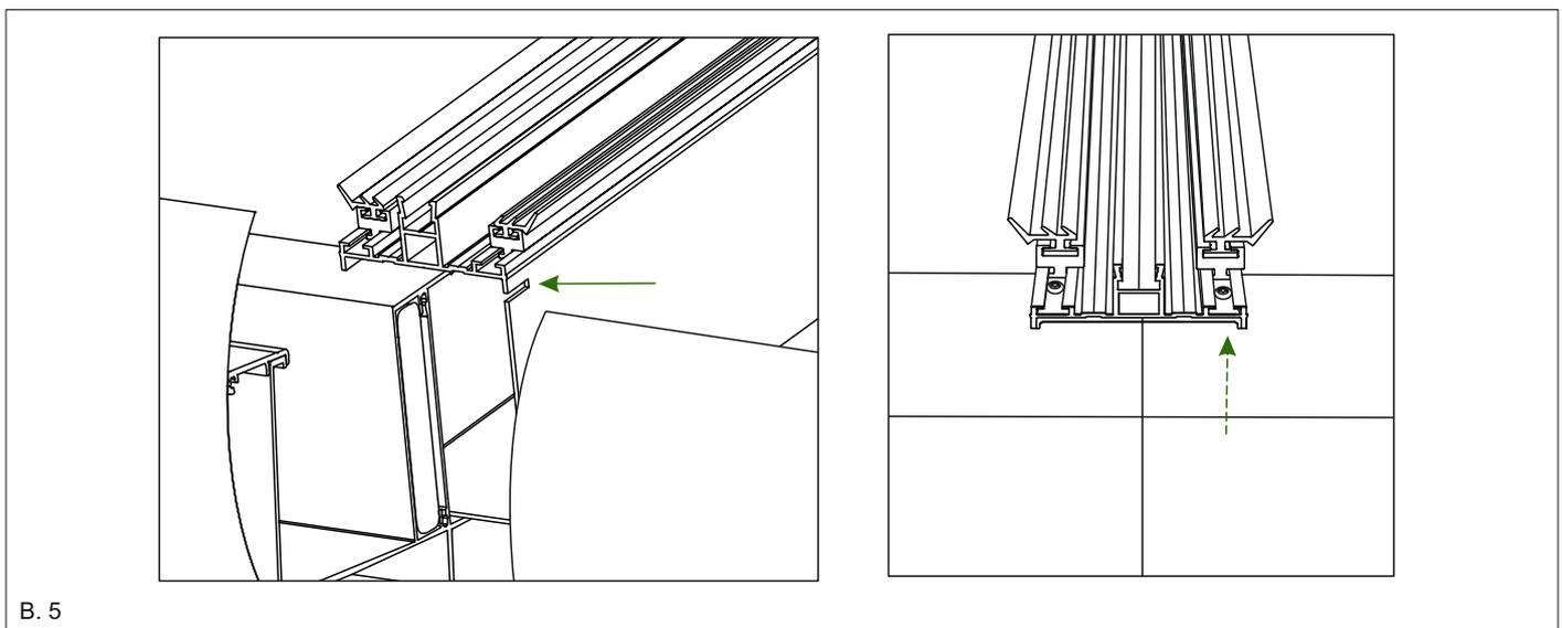
3. Schieben Sie nun das Verbindungsstück mittig über die Schnittstelle der Beiden Rinneprofile und fixieren Sie es mit den mitgelieferten Schrauben (19 mm). Dichten Sie nun die Schnittstellen mit Silikondichtung ab. Siehe Bild 6.
