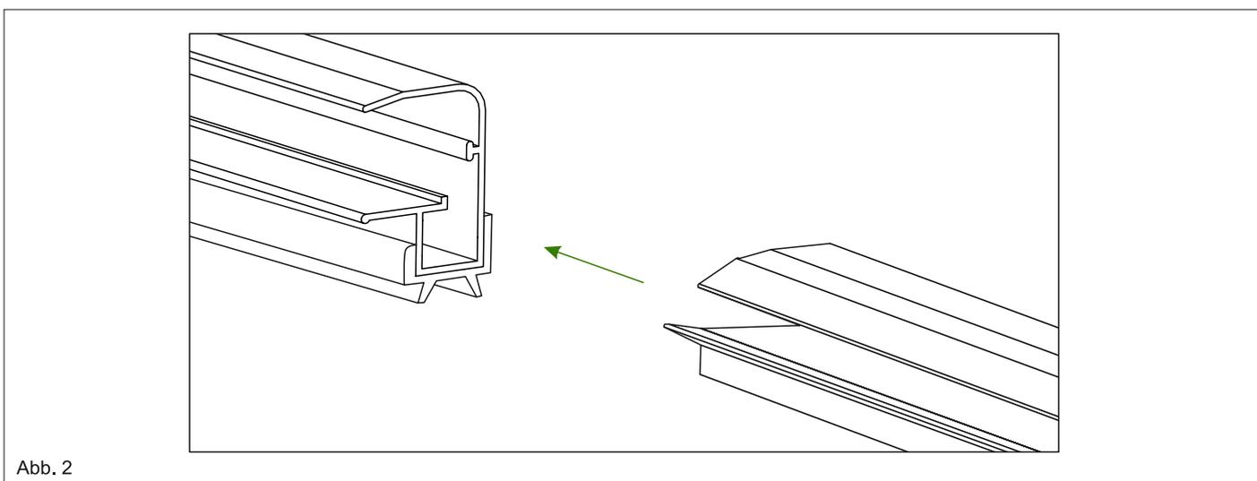
2. Als nächstes nehmen Sie die Klickleisten KL-A980 und setzen Sie ebenfalls die Gummidichtung hinein. Auch hier den Vorgang mit allen gelieferten KL-A980 wiederholen, damit Sie zu jeder Klickleiste eine passende Gummidichtung haben. Siehe Bild 2.
