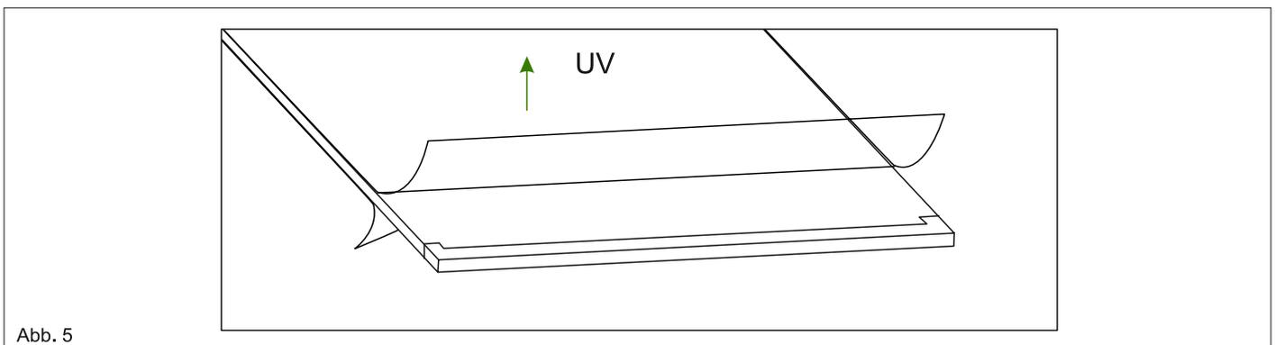
3. Nehmen Sie die Klickleisten KL-A935 und KL-A980 und verteilen Sie eine dünne Schicht Silikondichtung auf der Innenseite des Kantenprofils (Siehe Bild). Befestigen Sie die auf jede Polycarbonatplatte jeweils eine Klickleiste KL-A935 auf einer Seite und eine KL-A980 auf der anderen Seite. Achten Sie dabei, dass die UV-Seite oben bleibt. Wiederholen Sie diesen Vorgang mit allen gelieferten Polycarbonatplatten. Siehe Abb. 6.
