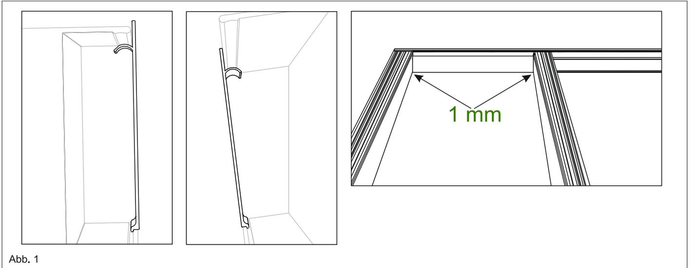
2. Nun schieben Sie den Mittelsparren mit dafür vorgesehenen Schlitz zuerst in das Wandprofil und dann in das Rinnenprofil bis zur (Abstand ca. 1 mm) Klickplatte hinein. Siehe Abb. 2.
