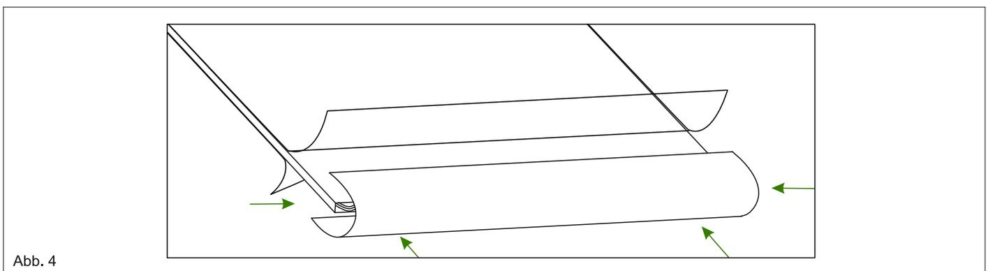
2. Die von uns gelieferten Polycarbonatplatten sind auf der UV-Seite mit der Michfolie überzogen. Diese Seite ist die Außenseite. Innenseite ist mit der durchsichtigen Folie geschützt. Zur Vorbereitung, befreien Sie die Polycarbonatplatten an den jeweiligen Enden auf beiden Seiten, circa 10 cm, von der Schutzfolie. Ziehen Sie die Schutzfolie noch nicht komplett ab. Siehe Abb. 5.
