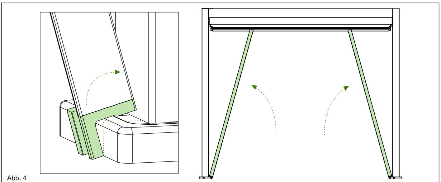
4. Schieben Sie die Markise beiseite, schieben Sie daraufhin die Schienenführung über das Verbindungsstück des Markisenkastens und rasten Sie sie ein. Kontrollieren Sie mit der Wasserwaage, ob alle Komponenten gerade im Rahmen sitzen. Siehe Abb. 5.
