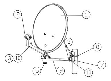
*Hinweis:* Zur Einstellung des richtigen Winkels (Elevation) verwenden Sie die Skala an der Camping Sat Antenne.
