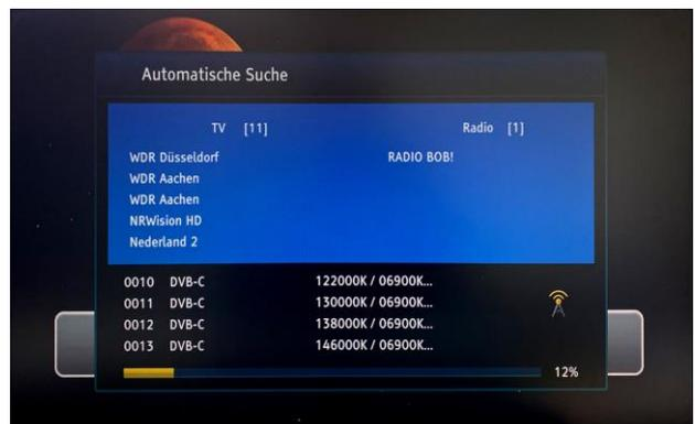
Nach der Bestätigung mit [OK] wird die Sendersuche automatisch gestartet. Alle im Receiver gespeicherten Frequenzen werden abgesucht.
