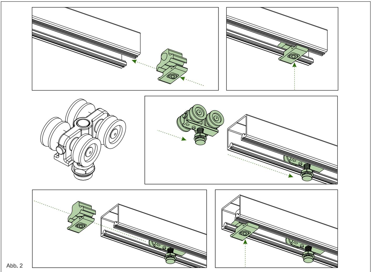
2. Montieren Sie die obere Schienenführung mit den beigelegten Torx Schrauben. Achten Sie darauf, das die obere Schiene bündig mit dem oberen Träger der Pergola platziert wird. Siehe Abb. 3.
