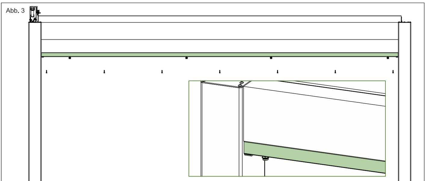
3. Sieben Sie die unteren Schienenschlitten in die untere Schienenführung. Legen Sie die untere Schiene bündig zu den Ausschnitten in der Pfostenkappe und befestigen Sie diese mit für Ihr Fundament geeigneten Schrauben/Bolzen. Siehe Abb. 4.
