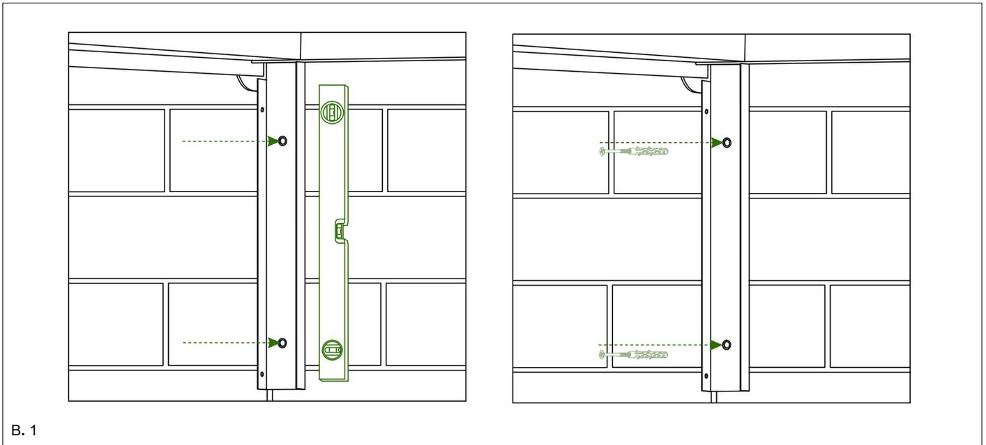
5. Bohren Sie nun Löcher in den Randsparren der Terrasse, für die Befestigung des Abschlusskeils, vor. Lassen Sie ca. 25 cm Abstand von den Rändern und ca. 50 cm Abstand zwischen den restlichen Bohrlochern.
