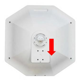
Um eine bessere Signalqualität zu erreichen, wird es am Rand der Ausleuchtzone womöglich nötig sein, den LNB-Kippwinkel etwas zu verändern. Lockern Sie dafür die Schrauben der Halterung und drehen Sie diese zuerst in eine und dann in die andere Richtung. Beobachten Sie dabei die Signalqualität, weil die Änderung auch zum kompletten Signalverlust führen kann. Im Normalfall (Deutschland, Österreich, Schweiz, BeNeLux) ist diese Änderung nicht notwendig.
