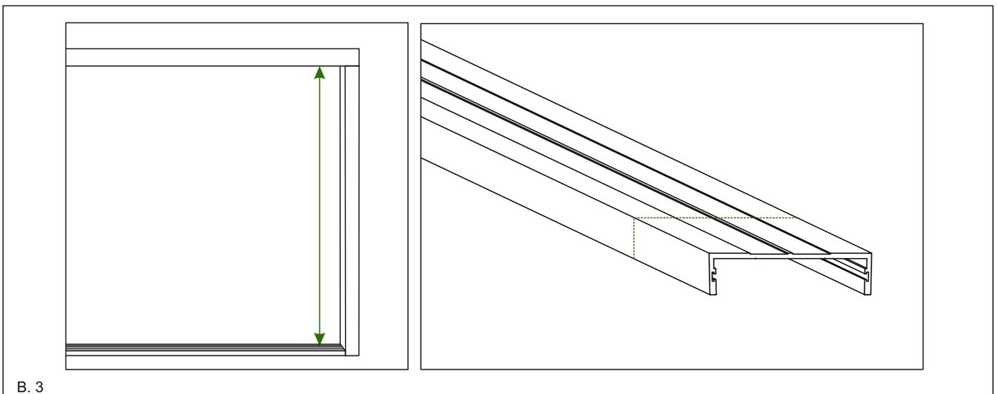
4. Schrauben Sie als nächstes die U-Profile an die Pfosten, Achten Sie darauf das die U-Profile senkrecht auf der Unterschiene platziert werden und genau aufliegen. Die Profile werden mit jeweils zwei Schrauben (6 Schrauben insgesamt) in 10 cm Abstand von der oberen und unteren Kante sowie in der Mitte befestigt. Siehe Bild 4.
