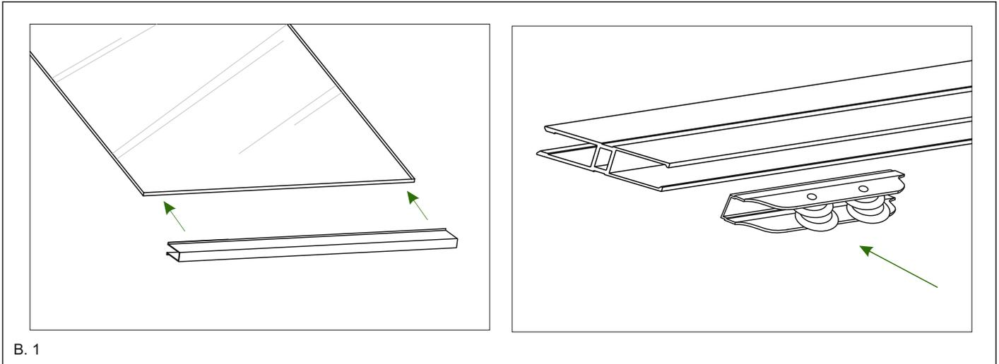
2. Bevor Sie die H-Profile an die Scheiben anbringen, befeuchten Sie die Gummidichtung mit Seifenwasser. Schieben Sie die H-Profile senkrecht auf die Gummidichtung und klopfen Sie diese mit einem Gummihammer fest. Bringen Sie nun die Abdeckung mit dem Gummistopper an das H-Profil mit dem gewölbten Ende nach unten zeigend an. Siehe Bild 2.
