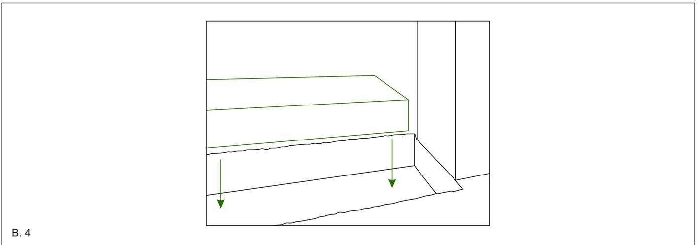
6. Messen Sie nun die Länge für die Ober- und Unterschien Ihres Glasschiebewandsystems. Schneiden Sie die Profile für die Glasschiebewand zu, lassen Sie ca. 2 bis 4 mm Spielraum beim zuschneiden der Profile mit der Kappsäge. Kürzen Sie überstehende Bürstenreste und drücken Sie die Enden der Bürstenfassungen an beiden Enden mit einer Zange zusammen. Durch das Zusammendrücken bleiben die Bürsten in Ihren Fassungen. Siehe Bild 5.
