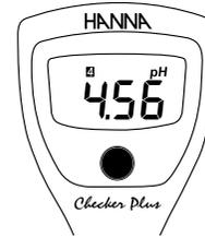
Tester geht in den Messmodus zurück. Der Kalibrier-Punkt wird oben angezeigt.
