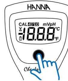
Drücken Sie die ON/OFF-Taste um das Messgerät einzuschalten. Alle Zeichen werden kurzzeitig auf dem Display angezeigt.
