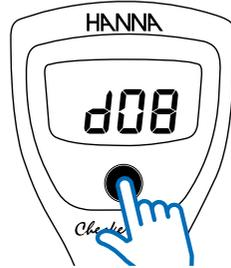
Drücken und halten Sie im Messmodus die ON/OFF-Taste solange bis nach "OFF" und "CAL" "d08" ("d60" oder "d--") erscheint.
