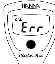
Erscheint im Kalibrier-Modus, trotz einer frischen Lösung, der Fehlercode "Err" sollten Sie die Elektrode reinigen. Tauchen Sie die Elektrode für ca. 15 Minuten in die HI700601 Reinigungs-lösung. Spülen Sie die Elektrode sorgfältig mit destilliertem Wasser und stellen Sie die Elektrode anschließend für ca. 1 Stunde in Aufbewahrungs-lösung. Taucht der Fehler anschließend erneut auf, muss die Elektrode HI1271 ausgetauscht werden.
