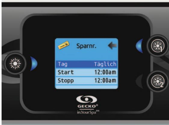
Der auf der Anzeige angezeigte Filtrierungszeitplan gilt für die Hauptfiltrierpumpe, üblicherweise Pumpe 1. Wenn ihr Spa mit einer Umwälzpumpe ausgerüstet ist, die so konfiguriert ist, dass sie 24 Stunden läuft, erscheint auf der Anzeige die Säuberungseinstellung statt der Filtrierung. Da die Säuberungen für eine bestimmte Anzahl von Minuten vorprogrammiert werden, wird die Dauer auf der Anzeige auf „n.v.“ gesetzt, und es kann nur die Startzeit geändert werden.
