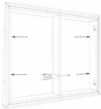
Verschrauben Sie den Schrank mit dem Einbaurahmen. Sie können die oberen und unteren Bohrlöcher der Bodenträger verwenden, sollten Sie diese nicht benötigen.
