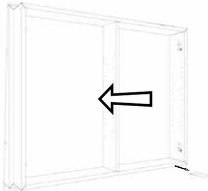
Setzen Sie den Schrank in den Einbaurahmen ein und entfernen Sie die Keile.
