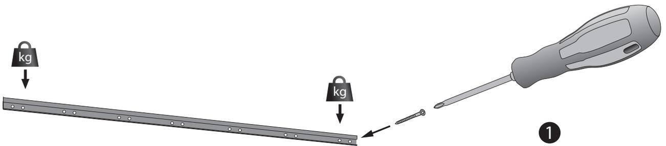
Befestigen Sie die Montageschiene mit Schrauben an allen gebohrten Löchern.
