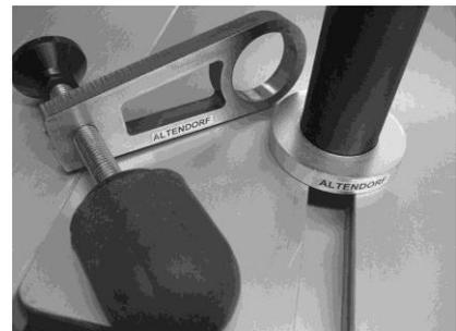
Der Abstand der T-Nute zum Sägeblatt bestimmt die Schwenkarmlänge.
