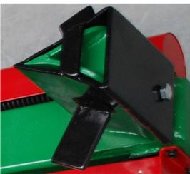
Das Spaltkreuz sollte möglichst nicht bei Harthölzern, wie Obstbäumen, Buche usw. Verwendung finden. Diese Hölzer setzen dem Spaltkreuz einen höheren Widerstand entgegen, der zu einer Auslösung des Überdruckventils führen kann. Eine Beschädigung der Maschine und die Verklebung des Holzes könnte die Folge sein.
