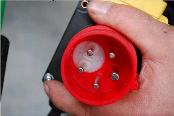
Bei den 400V Versionen dieses Holzspalters ist unbedingt auf die Drehrichtung des Motors zu achten. Eine falsche Drehrichtung beschädigt die Ölpumpe. In diesem Fall erlischt die Gewährleistung. Die Drehrichtung kann durch einen Elektrofachmann direkt im Schalter mit Hilfe eines Schraubenschlüssels geändert werden (Phasenwender)
