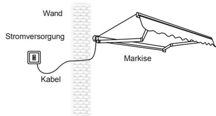
Sollten Sie sich dazu entscheiden die Markise nicht mittels dem Stecker an die Steckdose anzuschließen, sondern den Stromanschluß direkt zu legen so sollten die Bohrungen für die Wanddurchführung des Kabels ähnlich der Abbildung etwa 10 mm durch die Wand mit der elektrischen Versorgungsleitung gebohrt werden.
