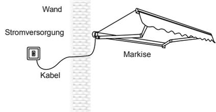
Sollten Sie sich dazu entscheiden die Markise nicht mittels dem Stecker an die Steckdose anzuschließen, sondern den Stromanschluß direkt zu legen so sollten die Bohrungen für die Wanddurchführung des Kabels ähnlich der Abbildung etwa 10 mm durch die Wand mit der elektrischen Versorgungsleitung gebohrt werden.
