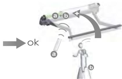
Drücken Sie nun innerhalb von maximal 6 Sekunden den „P2“ Knopf auf dem Wettersensor.
