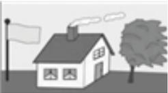
Die Markise darf bis maximal Windstärke 5 ausgefahren bleiben. Definition nach Beaufort: frische Brise, frischer Wind. Kleine Laubbäume beginnen zu schwanken, Schaumkronen bilden sich auf Seen. Geschwindigkeit 28 - 37 km/h = 7,5 - 10,4 m/s.
