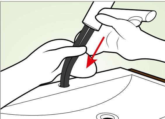
Stecken Sie die Armatür (Einlochbatterie) mit den Flexschläuchen in die Öffnung am Waschbecken und schrauben Sie sie fest. Hier ist etwas Vorsicht geboten. Achten Sie außerdem auf den korrekten Sitz der Gummiddichtungen.
