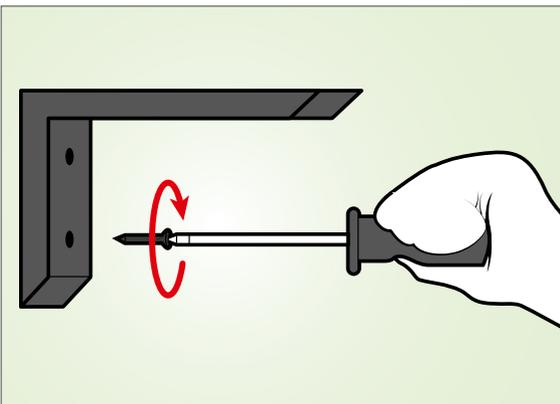
Richten Sie die Stegkonsolen an der Linie für die Unterkante der Waschtischplatte senkrecht aus. Verwenden Sie hierfür eine Wasserwaage. Übertragen Sie die Bohrlöcher und bohren Sie diese. Der Durchmesser der Löcher ist gleich dem Durchmesser der Dübel.
