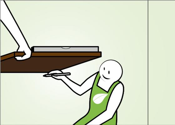
Bringen Sie die Waschtischplatte in die zuvor ermittelte Höhe (mit einem Helfer). Prüfen Sie nun die Position mit einer Wasserwaage und markieren Sie die Position des Tisches an der unteren Kante.
