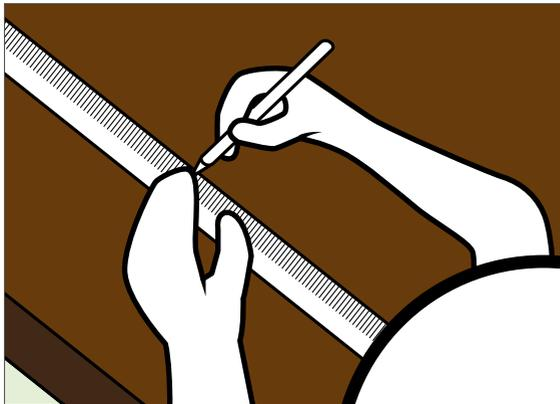
Legen Sie das Aufsatzwaschbecken auf die Waschtischplatte und positionieren Sie es an der gewünschten Stelle. Markieren Sie die Umriss mit einem Bleistift und übertragen Sie die Maße der Befestigungs- bzw. Anschlusslöcher vom Waschbecken auf die Tischplatte.
