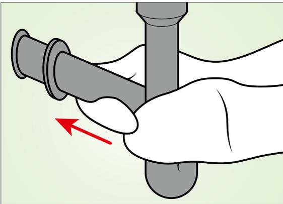
Nun müssen nur noch die Flexschläuche an den Eckventilen befestigt werden. Der Siphon wird in die Ablaufgarnitur eingeführt und das dazugehörige Abflussrohr verbinden Sie mit dem Abschluss in der Wand. Jetzt montieren Sie noch das Exzentergestänge und Ihr Aufsatzwaschbecken ist fertig montiert.
