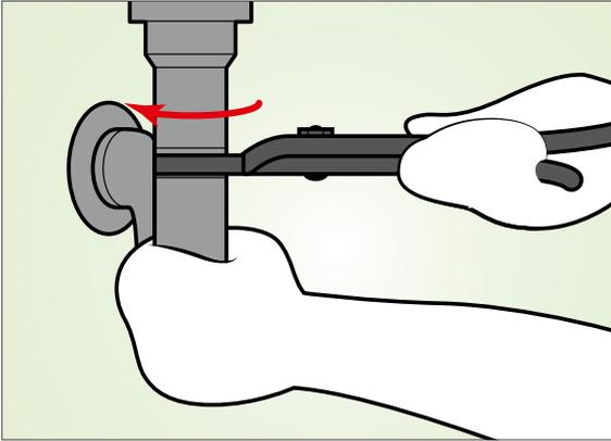
Befestigen Sie nun die Ablaufgarnitur in der dafür vorgesehenen Öffnung. Achten Sie darauf, dass die Gummidichtungen und der Exzenter ordnungsgemäß befestigt werden.
