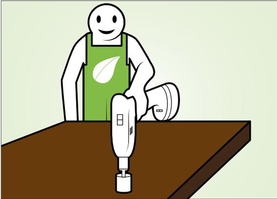
Bohren oder sägen Sie die markierten Löcher in die Waschtischplatte. Es empfiehlt sich hierfür eine Lochsäge zu verwenden. Natürlich können Sie auch ein großes Loch in die Platte sägen und dann das Waschbecken an den Rändern positionieren.
