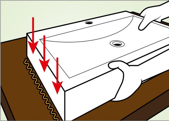
Vor dem Aufsetzen des Beckens tragen sie etwas Sanitärsilikon auf. Orientieren Sie sich dabei an dem zuvor aufgezeichneten Umriss. Überquellendes Silikon entfernen Sie mit Hilfe eines Glätters. Bringen Sie nun die Schrauben und Dübel zum Befestigen des Waschbeckens an.
