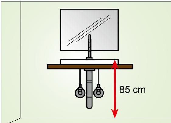
Das Waschbecken sollte eine Höhe von 85 Zentimetern haben. Gemessen wird hierbei vom Boden bis zur Oberkante des Waschbeckens. Ziehen Sie von den 85 Zentimetern die Höhe des Waschbeckens und die Stärke der Waschtischplatte ab. Nun haben Sie den Wert vom Boden bis zur Unterkante der Platte.
