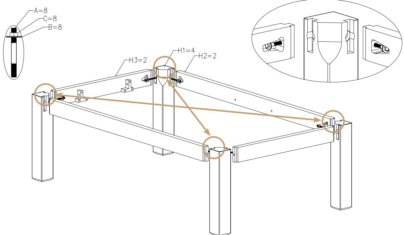
Achten Sie beim Zusammenbauen des Grundrahmens darauf, dass die beiden mit Pfeilen gekennzeichneten Diagonalen gleich lang sind.
