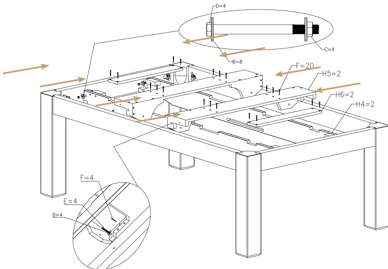
Vermitteln Sie die Querstreben seitlich zu den langen Seitenteilen und setzen Sie diese ein. Achten Sie darauf, dass auf keiner Seite die Querstreben unter Druck eingesetzt und fixiert werden..
