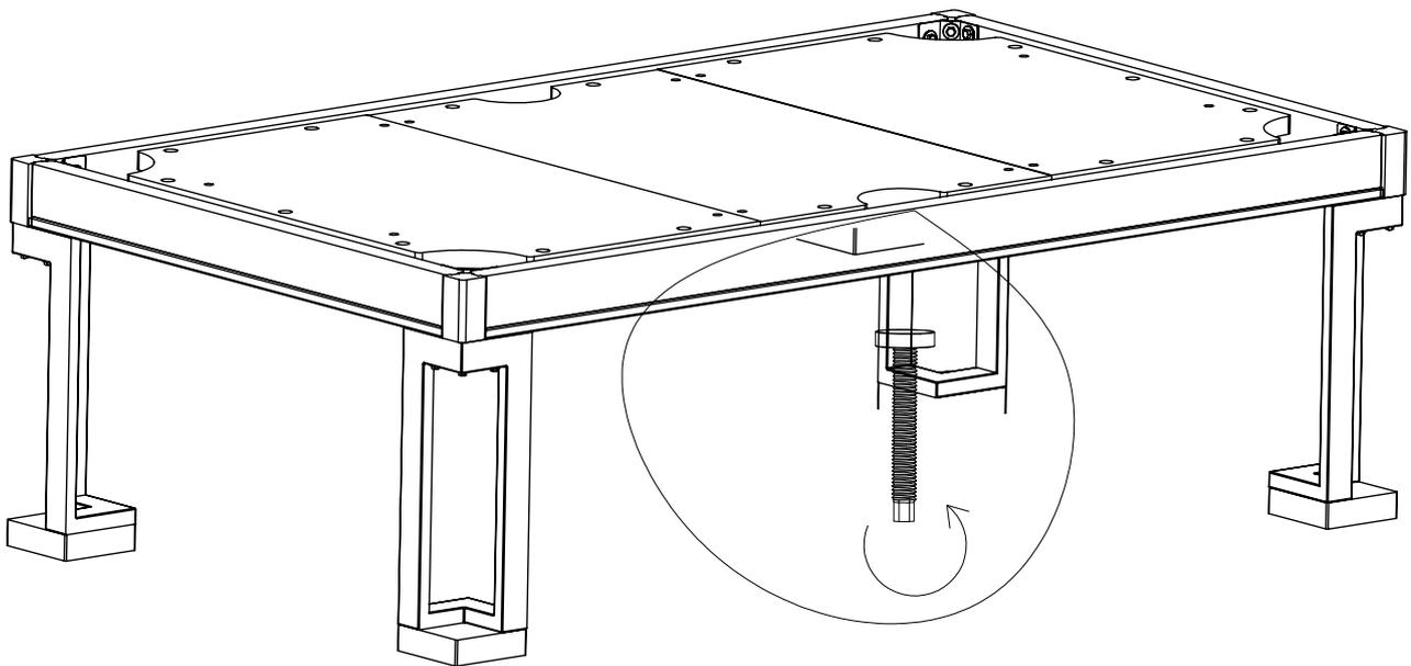
Stellen Sie die Nivellierung von unten mit einem Gabelschlüssel ein, um die Schieferplatten auszurichten.
