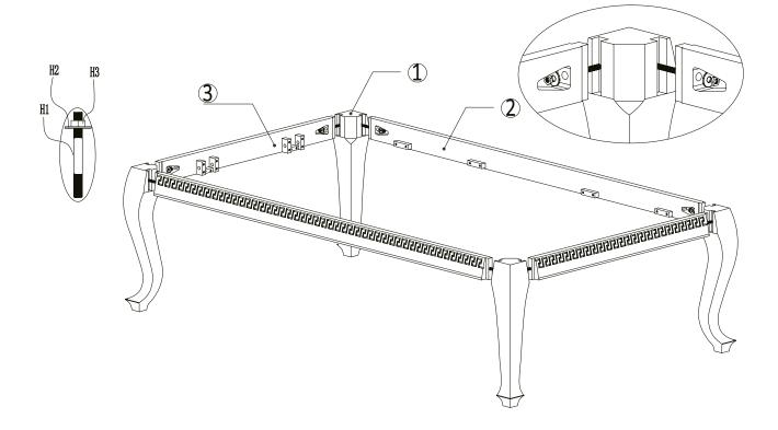
Achten Sie beim Zusammenbauen des Grundrahmens darauf, dass die beiden mit Pfeilen gekennzeichneten Diagonalen gleich lang sind.
