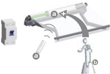
Drücken Sie nun innerhalb von maximal 6 Sekunden den „P2“ Knopf auf dem Wettersensor.
