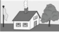
Die Markise darf bei Wind nicht genutzt werden. Die Windwiderstandsklasse 0 entspricht (nach DIN EN 13561) entweder einer nicht geforderten oder nicht gemessenen Leistung oder einem Produkt, das die Anforderungen der Klasse 1 nicht erfüllt.
