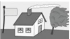
Die Markise darf bis maximal Windstärke 6 ausgefahren bleiben. Definition nach Beaufort: starker Wind. Starke Äste schwanken. Regenschirme sind schwer zu halten. Telegrafentleitungen pfeifen im Wind. Geschwindigkeit 38 - 48 km/h = 10,5 - 13,4 m/s.
