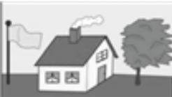
Die Markise darf bis maximal Windstärke 4 ausgefahren bleiben. Definition nach Beaufort: mäßige Brise, mäßiger Wind. Wind bewegt Zweige und dünnere Äste, hebt Staub und loses Papier. Geschwindigkeit 20 - 27 km/h = 5,5 - 7,4 m/s.
