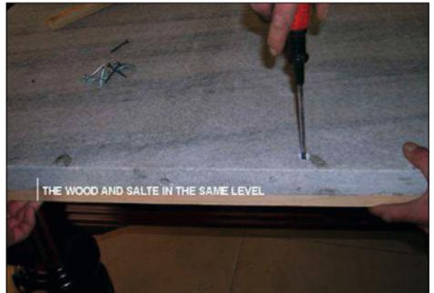
Befestigen Sie die Holzkonstruktion unter der Schieferplatte.
