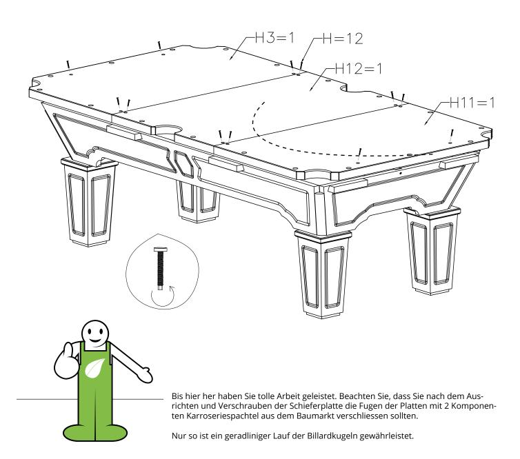
Anschließend beziehen Sie die Schieferplatte mit dem mitgelieferten Tuch. Versichern Sie sich zunächst, dass alle Schrauben fest angezogen sind!
