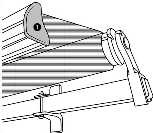
Hebeln Sie die Abdeckung mit einem geeigneten Werkzeug heraus. **2**
