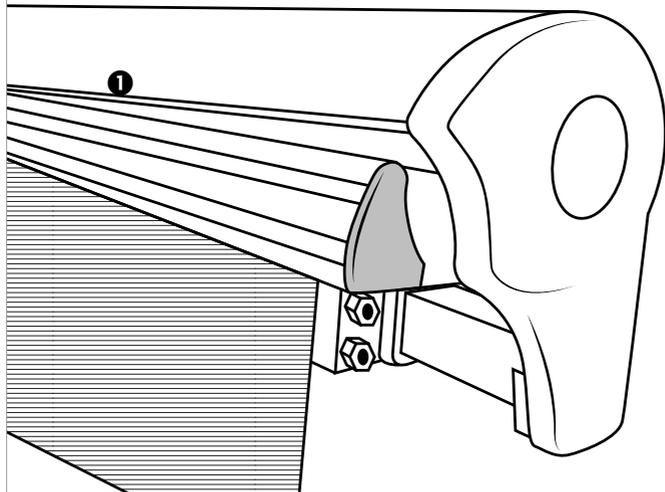
Hebeln Sie die Abdeckung mit einem geeigneten Werkzeug heraus. **2**
