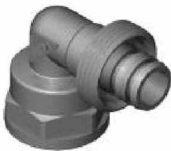
**1 FITTINGKÖRPER:** Der Fittingkörper wird im Warmpressverfahren aus Messing UNI EN 12165 CW617N gefertigt, stahlgestrahlt, maschinell bearbeitet und zum Schutz gegen die zunehmend aggressiven modernen Mörtel vernickelt.
