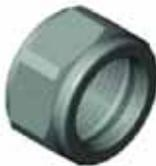
**5 ÜBERWURFMUTTER:** aus Messing UNI EN 12165 CW617N; warmgepresst, stahlgestrahlt, maschinell bearbeitet und abschließend vernickelt.
