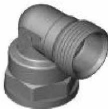
**1 FITTINGKÖRPER:** Der Fittingkörper wird im Warmpressverfahren aus Messing UNI EN 12165 CW617N gefertigt, stahlgestrahlt, maschinell bearbeitet und zum Schutz gegen die zunehmend aggressiven modernen Mörtel vernickelt.
