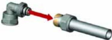
B) Das Rohr auf das Fitting schieben. Hierbei darauf achten, die O-Ringe nicht zu beschädigen. Das Rohr bis zum Anschlag schieben.
