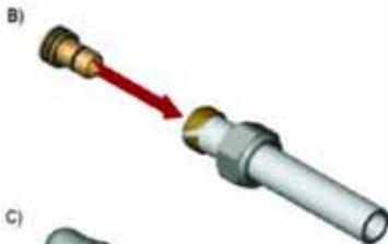
B) Das Rohr auf den Rohranschluss schieben. Hierbei darauf achten, den O-Ring nicht zu beschädigen. Das Rohr bis zum Anschlag schieben, damit es den Teflonring berührt.
