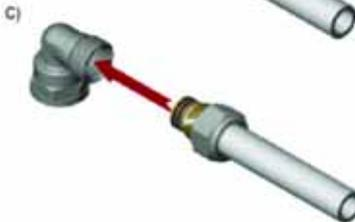
C) Das Rohr mit eingestecktem Rohranschluss in den Sitz des Fittingkörpers einsetzen.
