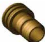
**6 ROHRANSCHLUSS:** aus Messing UNI EN 12164 CW 614N; maschinell aus gezogener Stange hergestellt. abziehsichere Kontur mit radialer Rändelung.
