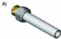
A) Die Überwurfmutter und den geschlitzten Klemmring auf das Fitting schieben. Da der Klemmring symmetrisch ist, gibt es keine spezielle Einbaurichtung, was die Installation weiter vereinfacht.
