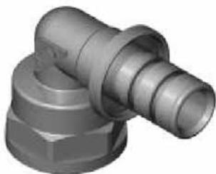
**1 FITTINGKÖRPER:** Der Fittingkörper wird im Warmpressverfahren aus Messing UNI EN 12165 CW617N gefertigt, stahlgestrahlt, maschinell bearbeitet und zum Schutz gegen die zunehmend aggressiven modernen Mörtel vernickelt.
