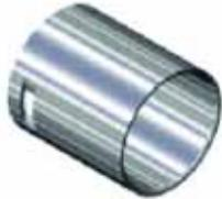
**4 PRESSHÜLSE:** Sie besteht aus geblühtem und vernickeltem Messing UNI EN 4892 CW508L und muss nach dem Verpressen einen ausreichend großen radialen Druck auf das Rohr und den Rohranschluss ausüben, um die Dichtheit und die Festigkeit der Verbindung zu garantieren.
