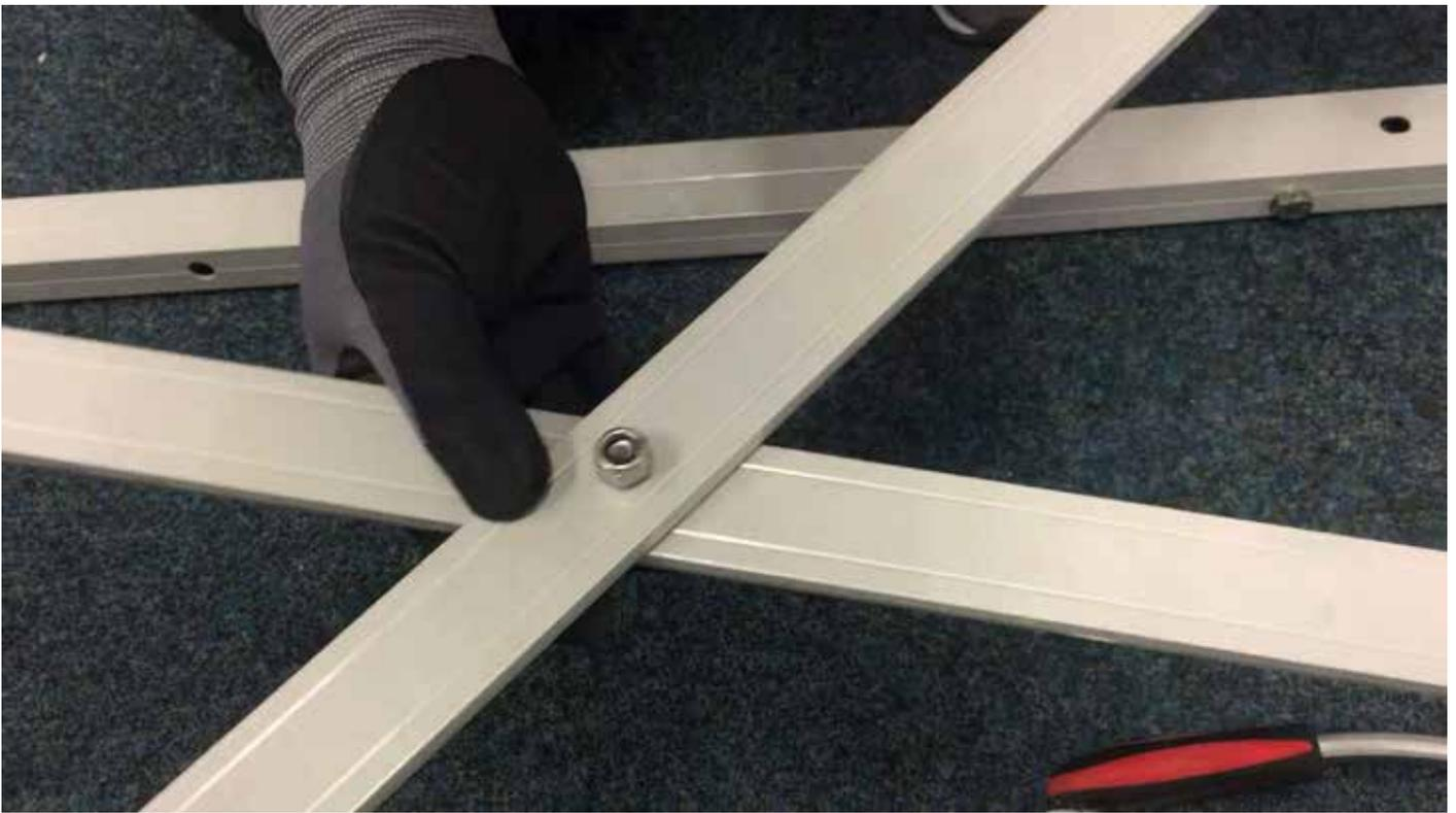
Nachdem die FüÙe montiert sind, verbinden sie diese beiden Streben mit dem Rahmenkreuz. Verschrauben Sie dazu die beiden Flachprofile in der Mitte.
