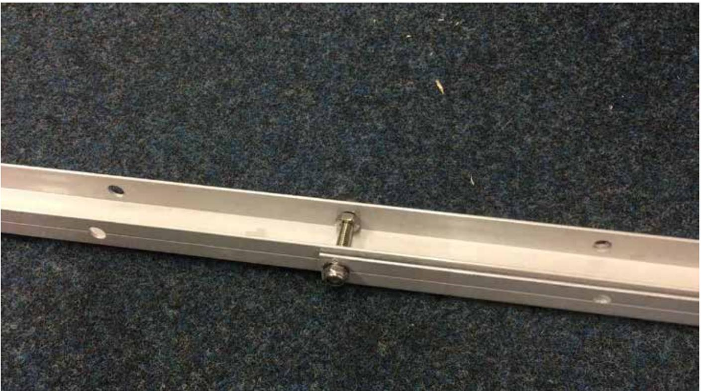
Nun verschrauben Sie die Profile mit einer selbstsichernden Mutter.
