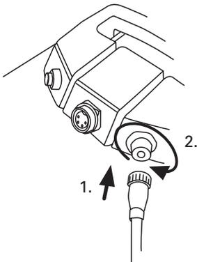
Der Stecker des Solarmodulkabels wird in die Ladebuchse der Batterie gesteckt und wasserdicht verschraubt.
