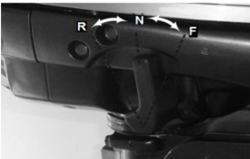
Der Motor hat drei Schaltpositionen: Vorwärts (F), Rückwärts (R) und Leerlauf (N). Reduzieren Sie von Vollgas auf die Leerlaufdrehzahl. Schalten Sie den Motor immer mit einer schnellen Bewegung in den Gang.
