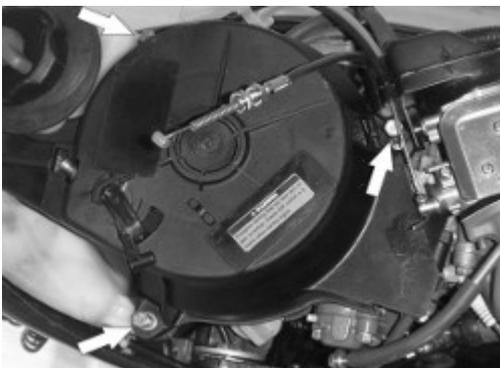
4. Entfernen Sie die drei Bolzen. Entfernen Sie darauf den Starter.
