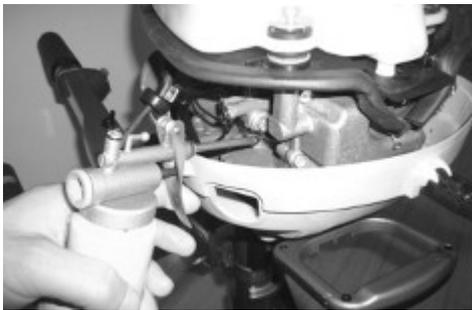
5. Geben Sie einen Motorkonservierer oder Motoröl in den Vergaser und die Einbauöffnungen der Zündkerze(n), während Sie den Motor mit dem Startseil oder dem Notfallstartseil ankurbeln.
