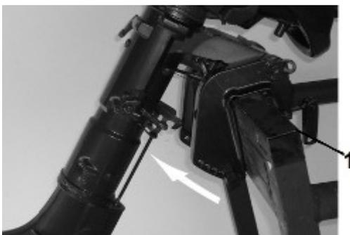
Die Kipp Sperre verhindert, dass sich der Motor aus dem Wasser hebt, wenn er im Rückwärtsgang betrieben wird. Bringen Sie zum Sperren den Kipp sperren-Hebel (1) in die Sperren-Position, zum Entsperren in die Entsperren-Position.
