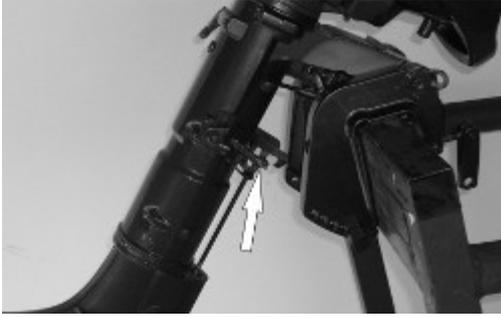
Die Kippstützen-Stange hält den Motor in hochgekippter Position.
