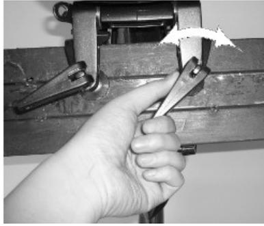
Wenn Ihr Außenbordmotor über eine Rückhaltevorrückung verfügt, benutzen Sie eine Motor-Rückhalte-Trosse oder Kette. Befestigen Sie ein Ende an der Rückhaltevorrückung und das andere am einem sicheren Befestigungspunkt auf dem Boot. Ansonsten können Sie den Außenbordmotor komplett verlieren, wenn er vom Heck fällt.
