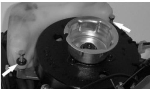
5. Bringen Sie zur Sicherung des Tanks zwei Bolzen wieder an.
