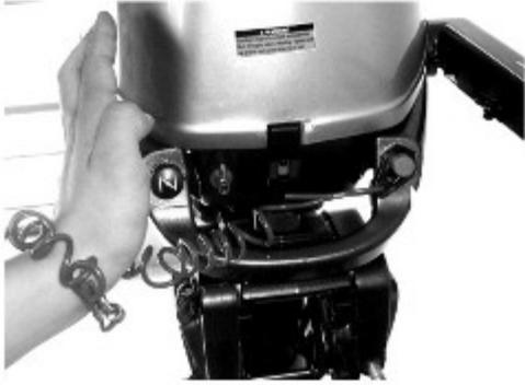
2. Wenn der Außenbordmotor mit einer Notstop-Leine ausgestattet ist, befestigen Sie den Haken an einer sicheren Stelle an der Kleidung des Bootsführers (oder am Arm/Bein), wenn der Motor in Betrieb ist. Befestigen Sie das Schloss am anderen Ende der Leine am Motor-Aus-Schalter (2). Ansonsten können Sie den Motor nicht starten.
