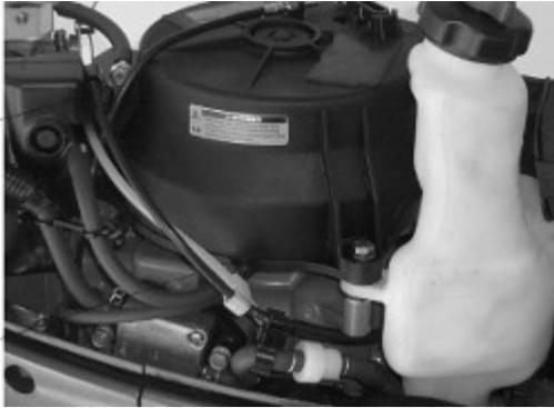
2. Entfernen Sie das Start-im-Gang Schutzkabel und das Choke-Kabel vom Halter am Starter. Nach dem Entfernen des Choke-Kabels müssen Sie dessen Ende in den Auspufftopf schieben, so dass es diesen berührt.
