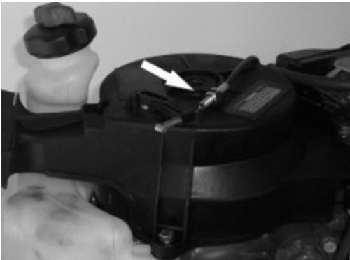
3. Entfernen Sie das Ende des Start-im-Gang Schutzkabels, indem Sie es vom Hebel des Starters abziehen, nachdem Sie die Mutter gelöst haben.
