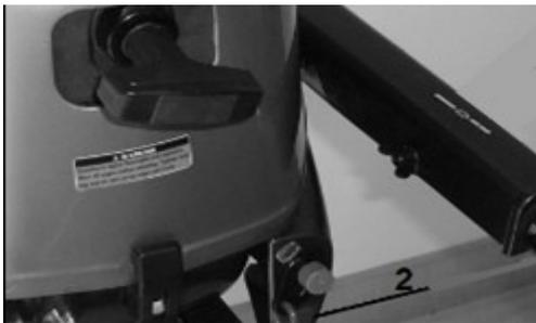
Das Notstop-Schloss muss am Motor-Aus-Schalter (2) angeschlossen sein, damit Sie den Motor in Betrieb nehmen können. Befestigen Sie den Haken an einer sicheren Stelle an der Kleidung des Bootsführers (oder am Arm/Bein).
