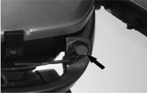
Drücken Sie diesen Schalter, um die Zündung zu unterbrechen und den Motor abzuschalten.
