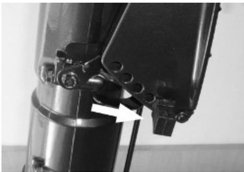
Die Position der Schubstange bestimmt den minimalen Trimmwinkel des Außenbordmotors in Beziehung zum Spiegel.
