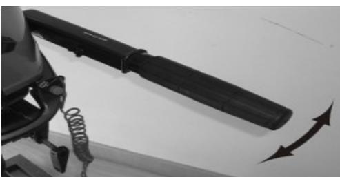
Der Gasgriff befindet sich am Rudergriff. Drehen Sie den Griff zum Erhöhen der Geschwindigkeit gegen den Uhrzeigersinn. Drehen Sie den Griff zum Verringern der Geschwindigkeit im Uhrzeigersinn.
