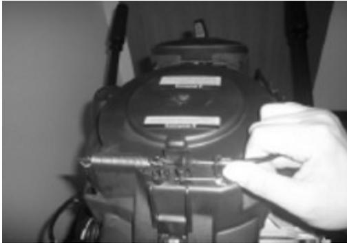
2. Entfernen Sie das Kabel der Start-im-Gang Schutzvorrichtung und das Choke-Kabel.
