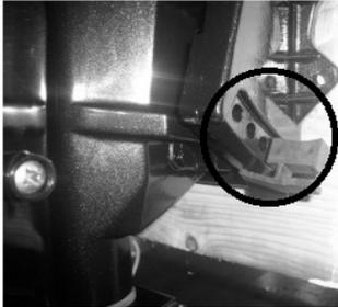
Führen Sie Testfahrten mit verschiedenen Trimmwinkeln durch, um den für das Boot und die Betriebsbedingungen am besten geeigneten Trimmwinkel zu bestimmen.
