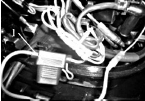
Wenn bei einem Modell mit elektrischer Starthilfe eine Sicherung durchgebrannt ist, öffnen Sie den Sicherungen-Halter und ersetzen Sie die Sicherung durch eine neue Sicherung derselben Art und Leistung. Fragen Sie Ihren Händler um Rat, wenn eine neue Sicherung sofort wieder durchbrennt.
