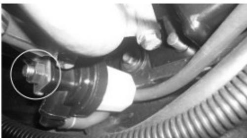
1. Entfernen Sie die Mutter, die die Filteranordnung hält.
