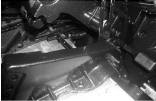
4. Halten Sie den hinteren Griff und kippen Sie den Motor vollständig hoch, bis der Kipphilfshebel automatisch einrastet.
