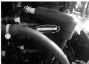
Die Seriennummer des Motors ist in die Aluminiumummantelung des Motors gefräst.
