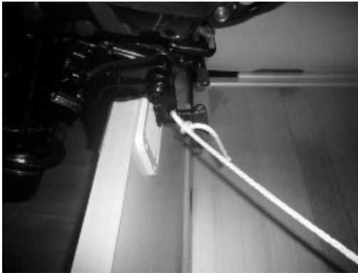
Wenn Ihr Außenbordmotor über eine Rückhaltevorrückung verfügt, benutzen Sie eine Motor-Rückhalte-Trosse oder Kette. Befestigen Sie ein Ende an der Rückhaltevorrückung und das andere am einem sicheren Befestigungspunkt auf dem Boot. Ansonsten können Sie den Außenbordmotor komplett verlieren, wenn er vom Heck fällt.
