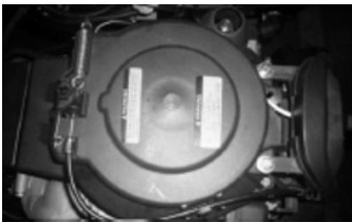
3. Entfernen Sie die drei Bolzen und den Starter.
