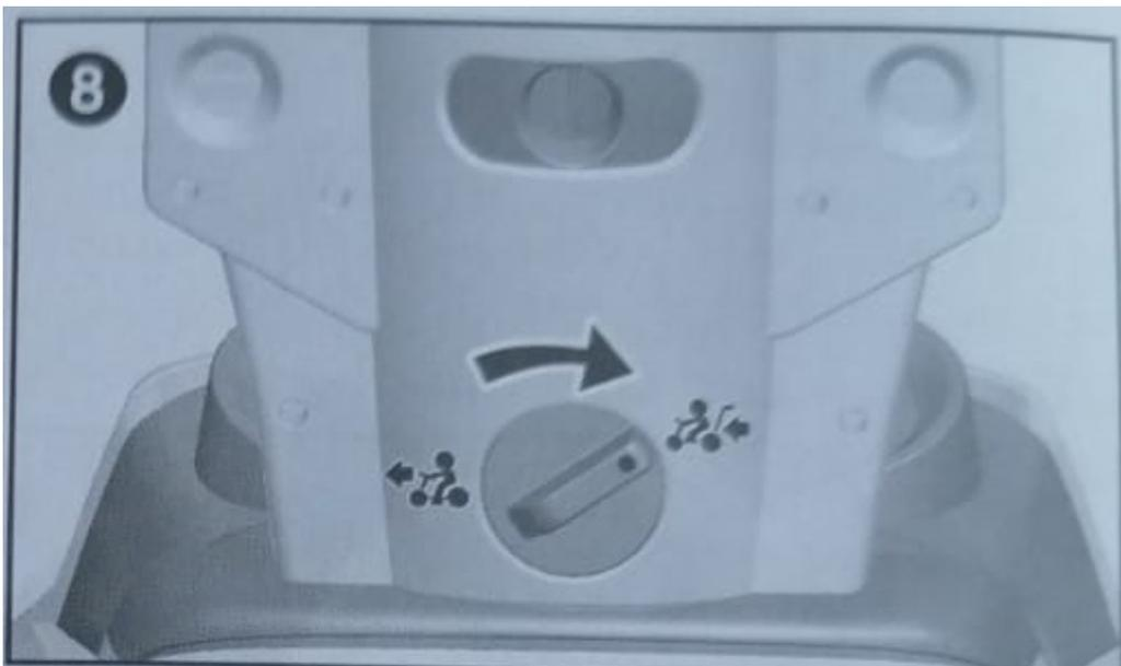
Drehen Sie den Knopf an der Rückseite der Rückenlehne in die in Abbildung 8 gezeigte Richtung, das ist die Funktion des Rollwagens.
