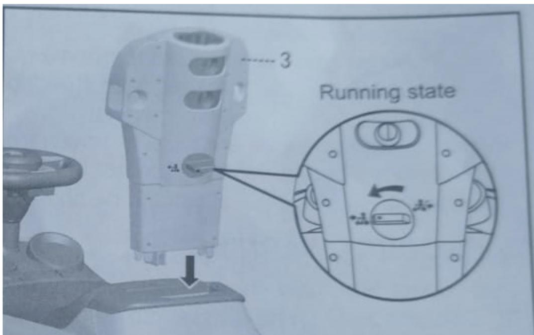
Drehen Sie vor der Montage der Rückenlehne (Teil 3) zunächst den Halteknopf der Rückenlehne in die auf dem Bild gezeigte Laufrichtung und setzen Sie ihn dann an der vorgesehenen Position hinten ein.
