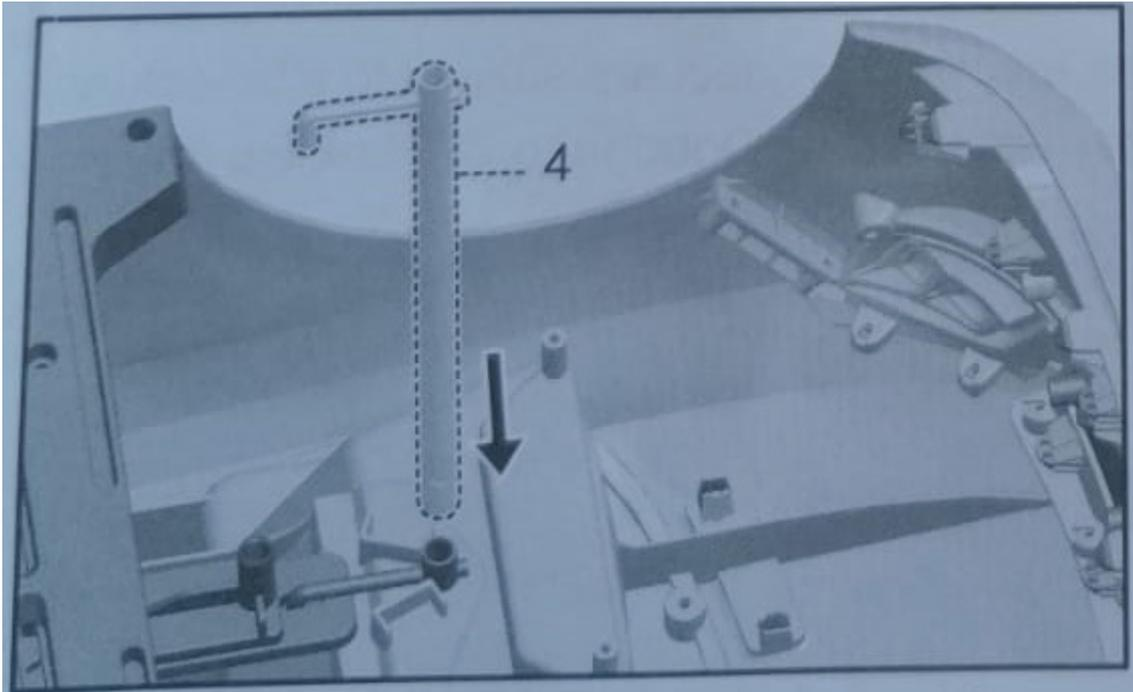
Drehen Sie den Wagen um und montieren Sie die Lenkradschwinge (Teil 4) in der vorgesehenen Position vor dem Wagen.
