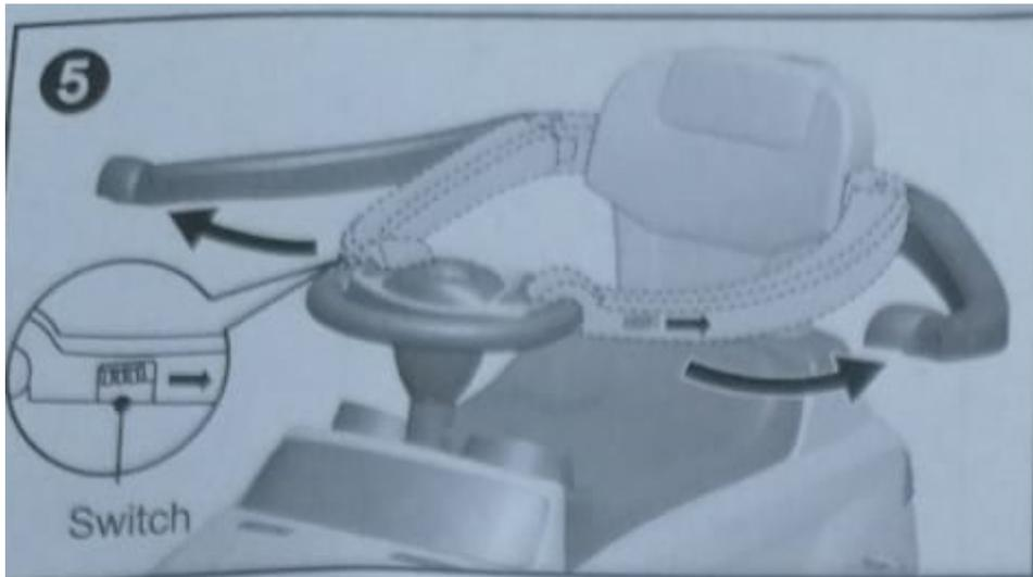
Drücken Sie den Schalter für den Schutzbügel, heben Sie ihn an und öffnen Sie ihn zu den beiden Seiten.
