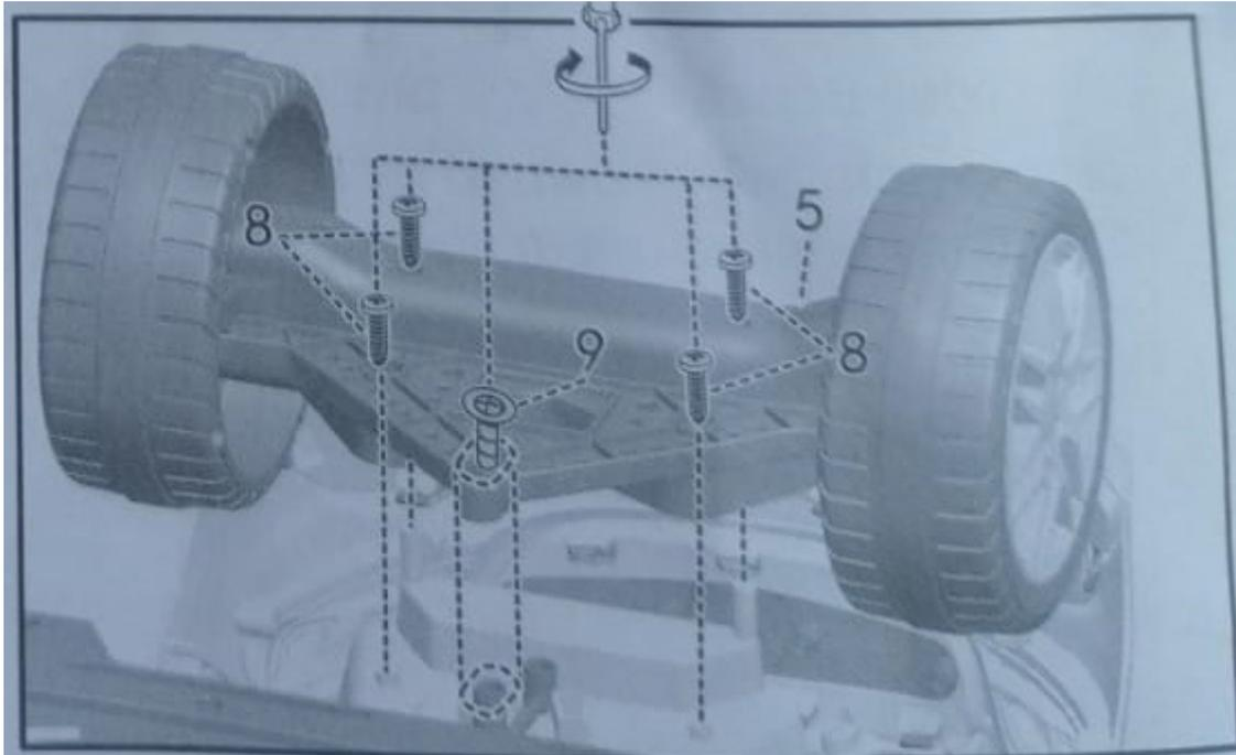
Bringen Sie das Lenkrad (Teil 5) in die vorgesehene Position an der Vorderseite des Wagens. Richten Sie das vordere Lenkrad vor der Montage mit dem Loch am Wagen aus und befestigen Sie es dann mit der Schraube (Teil 8) bzw. der Schraube (Teil 9)
