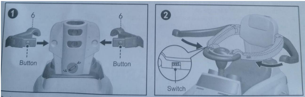
Drücken Sie den Knopf an den Handläufen und dem Schutzgeländer, fixieren Sie den linken und rechten Handlauf und das Schutzgeländer (Teil 6) in der vorgesehenen Position an den beiden Enden der Rückenlehne und heben Sie das andere Ende der Handläufe in die vorgesehene Position des Lenkrads.
