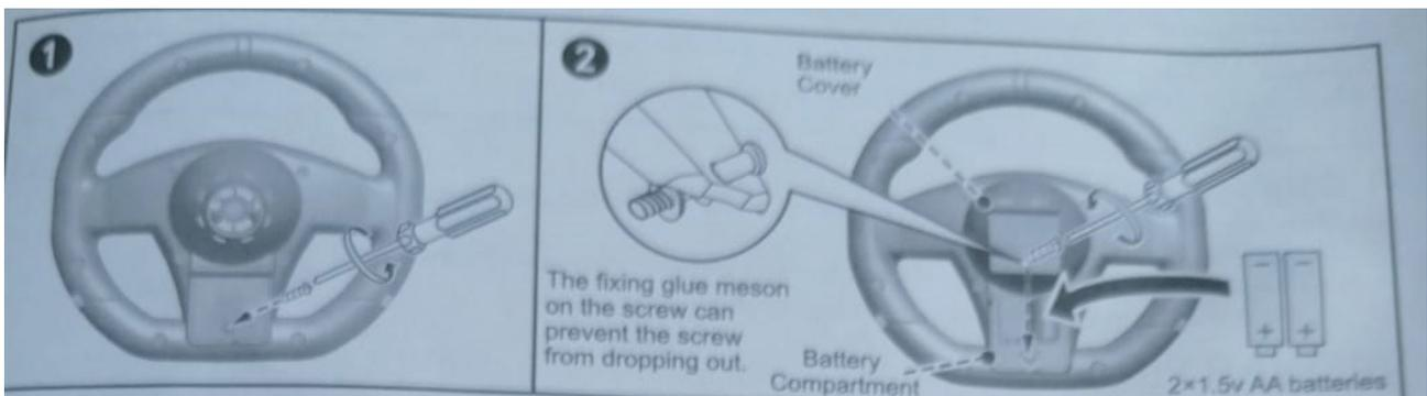
Der Batteriekasten befindet sich an der Unterseite des Lenkrads. Drehen Sie das Lenkrad um und öffnen Sie es, richten Sie Plus- und Minuspol der Batterie aus, setzen Sie zwei AA-Batterien ein, schließen Sie den Deckel und ziehen Sie die Schrauben fest.
