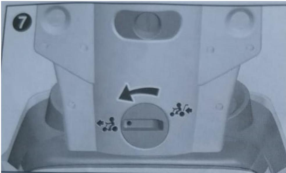
Drehen Sie den Knopf an der Rückseite der Rückenlehne in die in Abbildung 7 gezeigte Richtung, um die Funktion des Roller zu gewährleisten.
