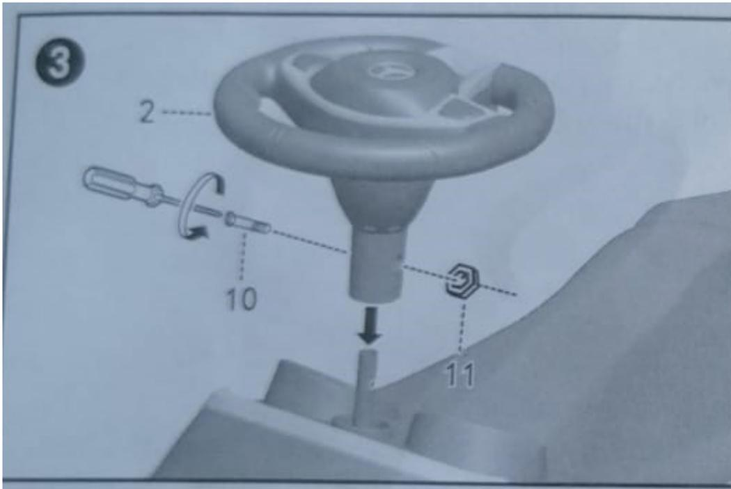
Stecken Sie das Lenkrad (Teil 2) in das obere Ende der Lenkradschwinge und ziehen Sie es dann mit der Schraube (Teil 10) bzw. der Schraubkappe (Teil 11) fest.
