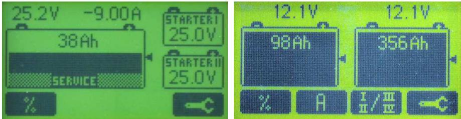
Alternativ kann per Tastendruck zwischen der Restkapazität in % und der Restzeit  $t$  umgeschaltet werden. Sind eine oder zwei weitere Batteriegruppen (Starter-Batterien) angeschlossen, so werden deren Spannungen automatisch auf dem Display eingeblendet.
